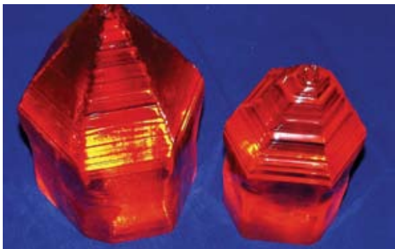
Рис. 1. Монокристаллы лантангаллиевого силиката, выращенные на ОАО "Фомос-Материалс"
